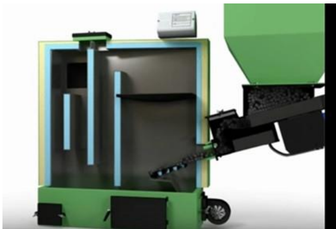
Rys. 7. Przykład kotła podsuwowego z automatycznym załadunkiem paliwa[ [ https://www.youtube.com/watch?v=StN0v4tBMOU ]
